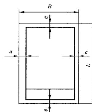
图 5 有装订边图纸(Y型)的图框格式
