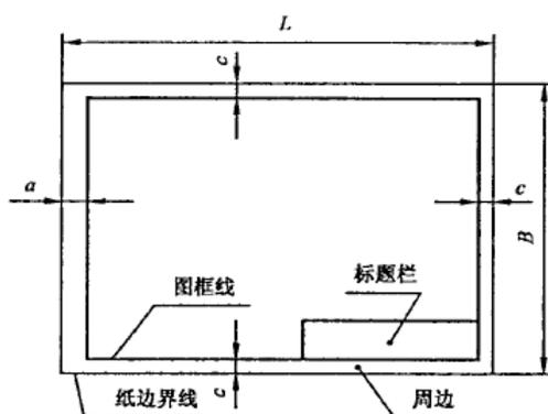
图 4 有装订边图纸(X型)的图框格式
